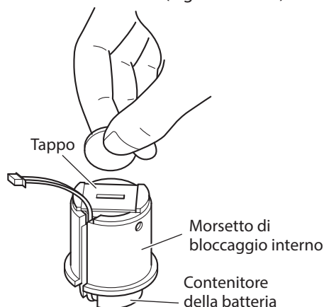
Figura 23 Rimozione del tappo della batteria
